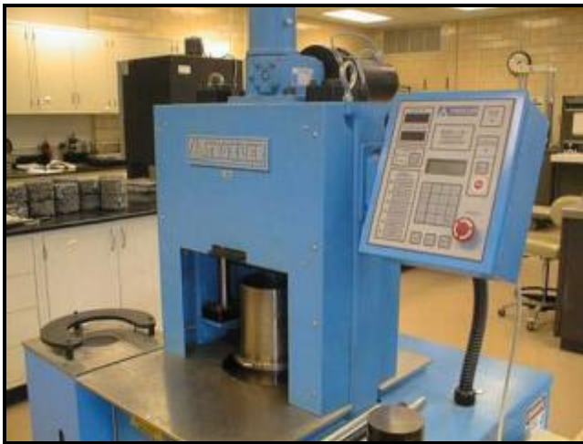
Figura A1 – Exemplos de modelos de compactador giratório Superpave
