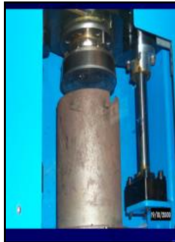
Molde e atuador de carga vertical
