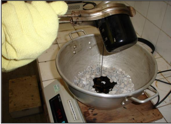
Adição do ligante aos agregados aquecidos
