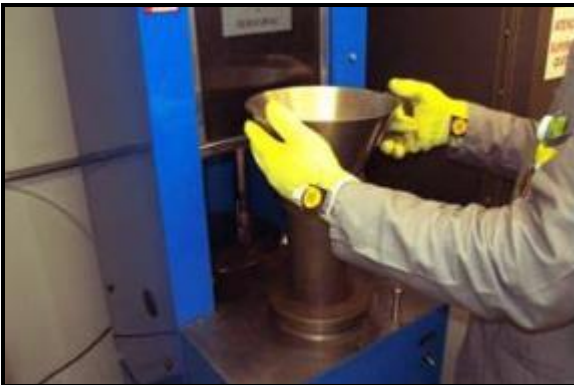
Colocação de funil no molde no compactador
