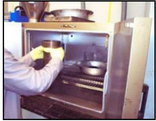
Aquecimento do molde em estufa
