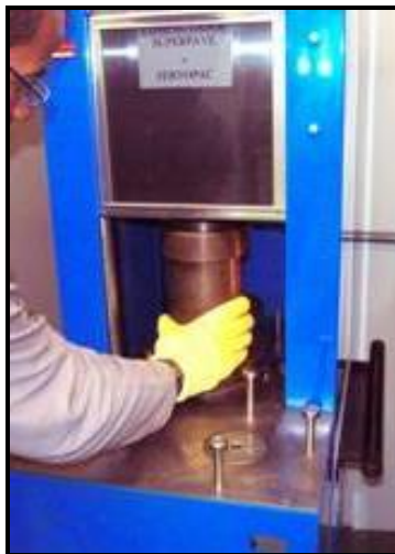
Molde sendo colocado no compactador
