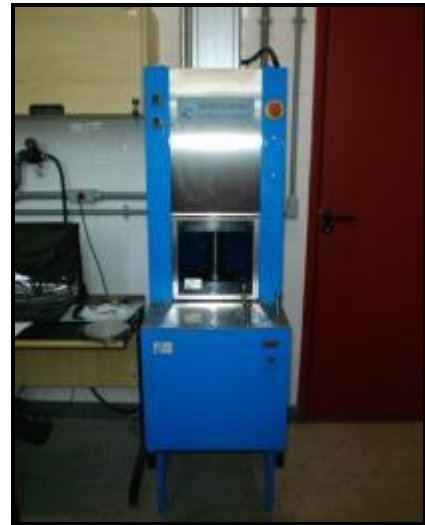
Figura A1 – Exemplos de modelos de compactador giratório Superpave
