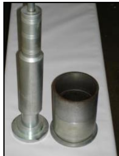
Soquete manual e molde montado
