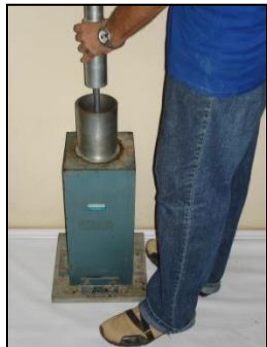
Esquema da compactação manual
