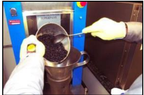
Colocação da massa no funil
