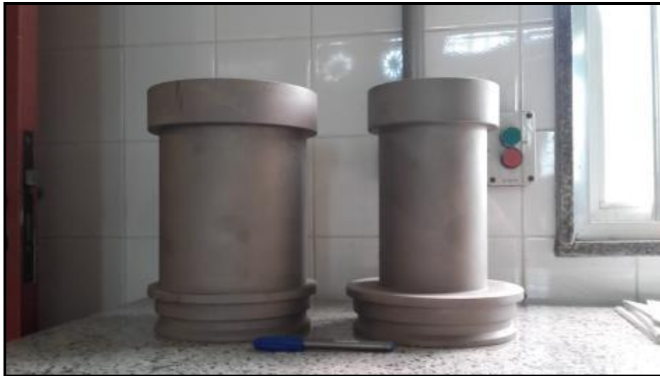
Figura A4 – Moldes do equipamento giratório (150 mm e 100 mm de diâmetro)
