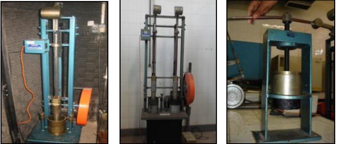
Figura A6 - Equipamento Marshall mecânico e extratora de corpo de prova Marshall
