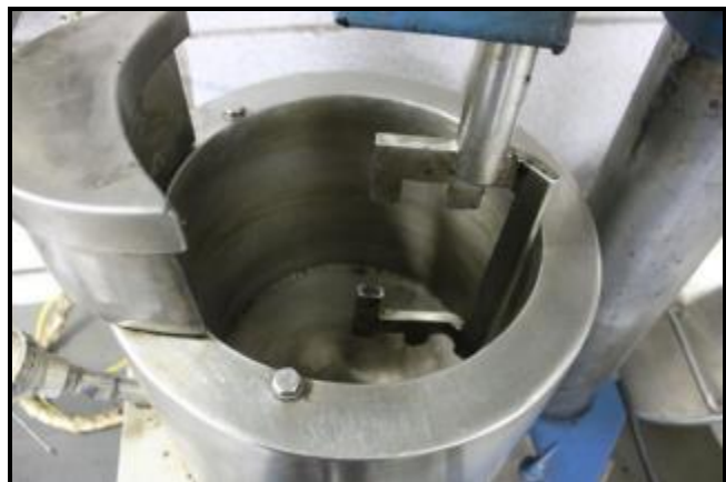
Figura A8 – Exemplos de misturadores mecânicos com controle de aquecimento.
