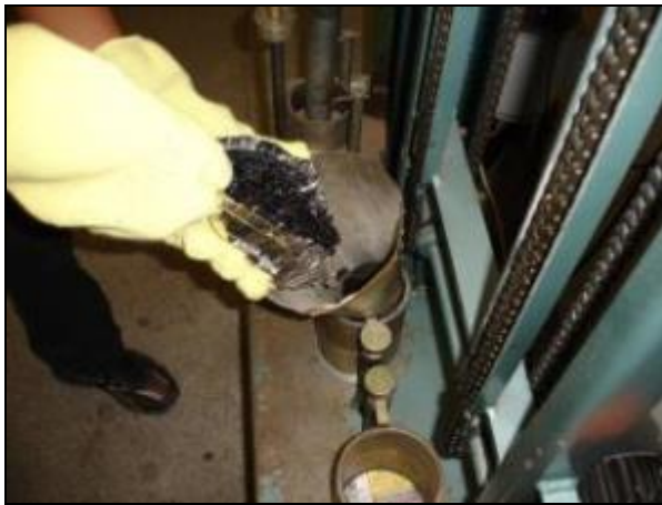
Colocação da mistura no molde
