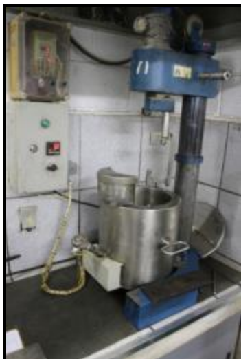
Figura A8 – Exemplos de misturadores mecânicos com controle de aquecimento.
