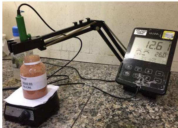
Figura 3: Exemplo de Leitura do pH de solo + cal
