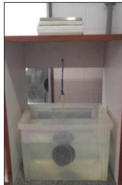
Pesagem do corpo de prova submerso
