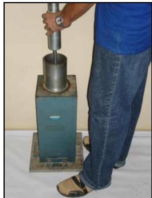
Esquema da compactação manual
