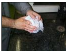
Pesagem do corpo de prova ao ar e superfície saturada e seca
