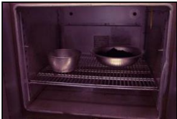
Aquecimento da massa asfáltica em estufa
