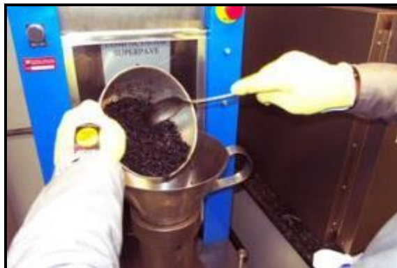
Colocação da massa no funil
