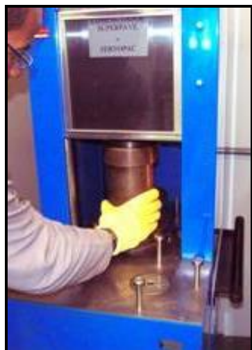
Molde sendo colocado no compactador
