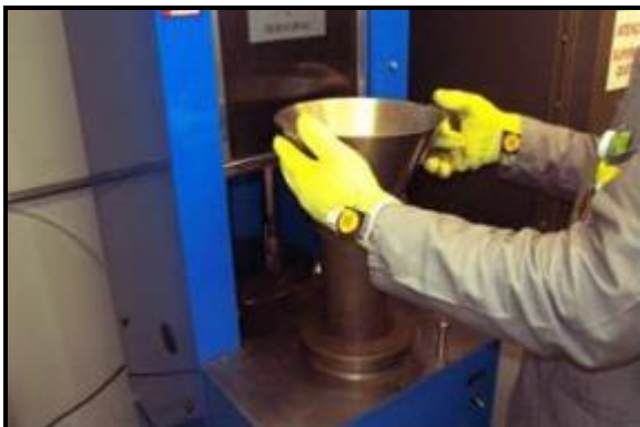
Colocação de funil no molde no compactador
