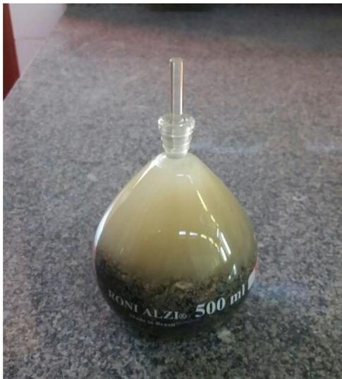
Picnômetro com amostra + água
