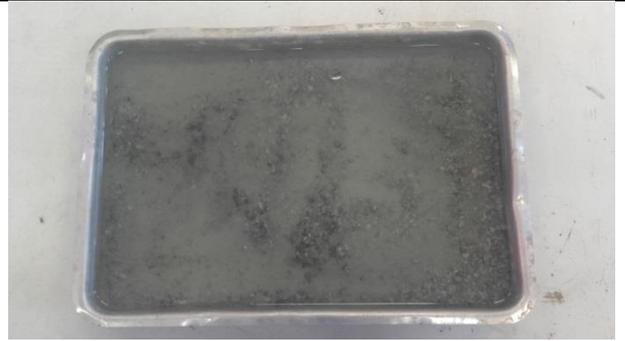
Amostra de agregado saturado por 24h
