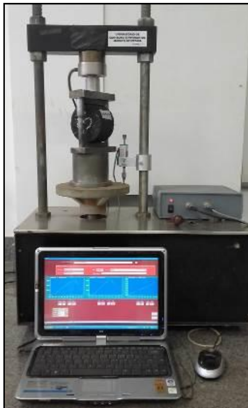
(b) Prensa com Sistema Automatizado com Célula de Carga
