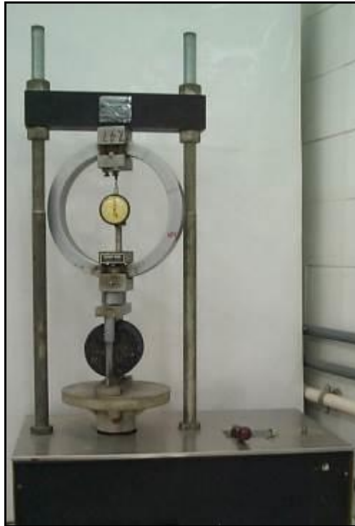
(a) Prensa com Anel Dinamométrico
