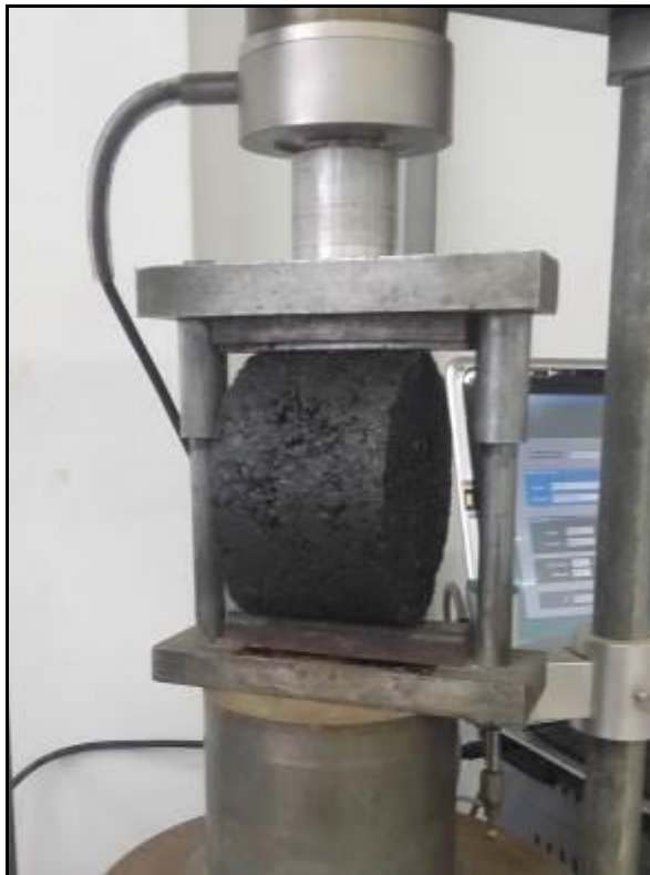
(a) – Dispositivo centralizador de corpo de prova.
