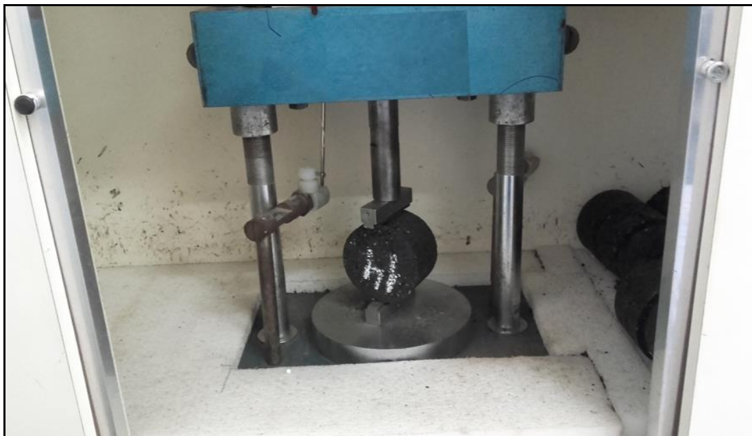
Figura 2 – Equipamento para previsão de fadiga, continuidade do ensaio realizado sem LVDT
